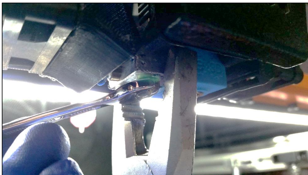
Rys 11.1. – wykręcanie dyszy z bloczka grzewczego
